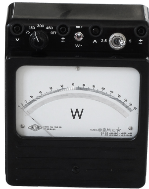
Figura 5: Wattmetro: simbolo grafico e corrispondente grandezza misurata
