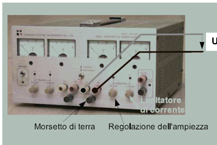
Fig. 1 – Alimentatore Topward TPS 4000. Sono indicate le caratteristiche salienti utili all'esecuzione dell'esperienza. Notare la spia, posizionata sopra la manopola per la limitazione della corrente, la cui accensione indica la condizione di cortocircuito tra morsetto positivo e negativo.
